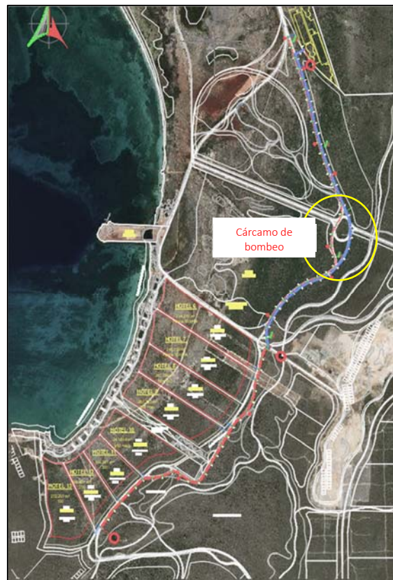
Figura 4. Planta general Alcantarillado Sanitario
