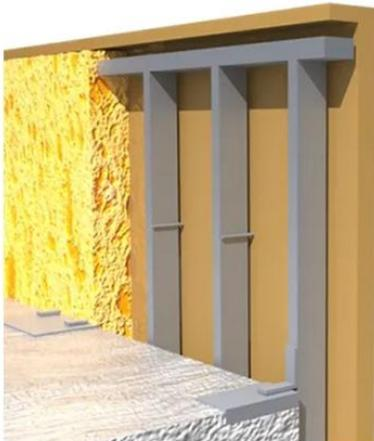
Lamina de GRC rigidizada mediante (un bastidor metálico).
