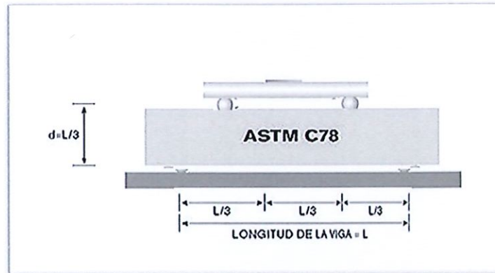
Figura 3. Ensayo Módulo de Rotura ASTM C78
